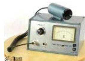
Luxmètre avec sonde, OIP, modèle 610
