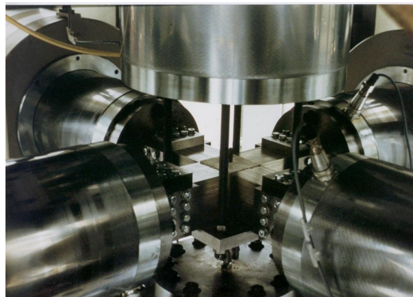
(d) Biaxial test on concrete
